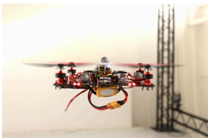
Figure 1 : Photo du drone miniature de 330 grammes X4-MaG développé au laboratoire. (Manecy et al. 2015, Int. J. of MAVs)
